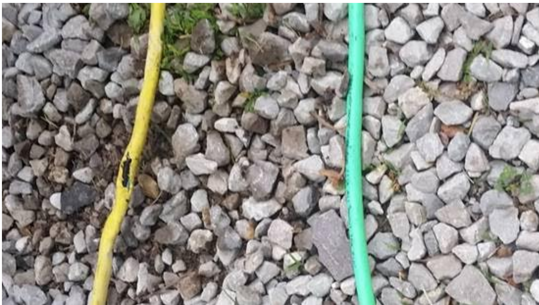
Figure 10. The yellow SJTW jacket vs. the green SJTOOW jacket.
